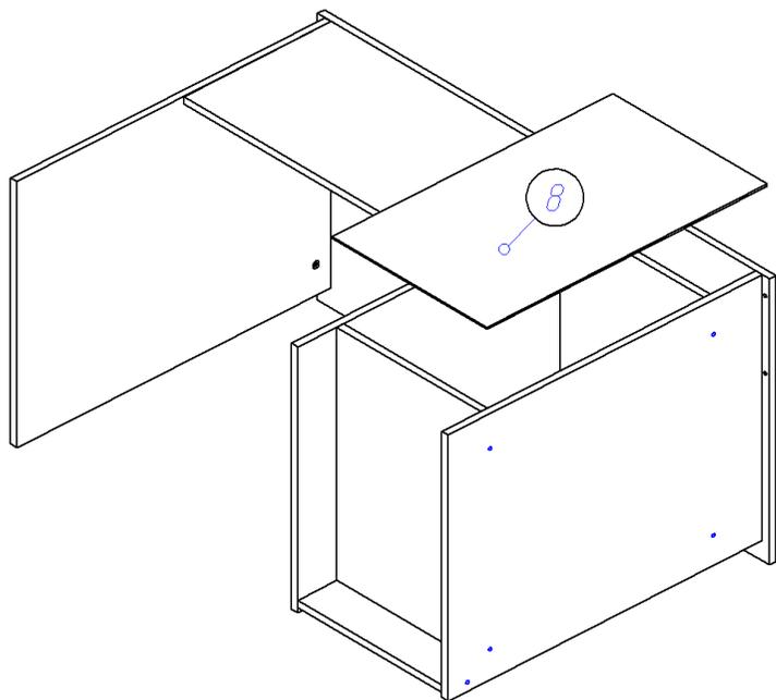
6. Соберем ящики. Евровинтами скрепляем бока ящика (Я.1, Я.2) и панель ящика (Я.3), прибиваем дно ящика ДВП (Я.5) (свес ДВП с незакромлённой стороны 6 мм). С помощью эксцентриковой стяжки крепим фасад (Я.4) к корпусу ящика (ДВП попадает в паз фасада). Прикручиваем с помощью саморезов 3,5\*16 направляющие на ящики.
